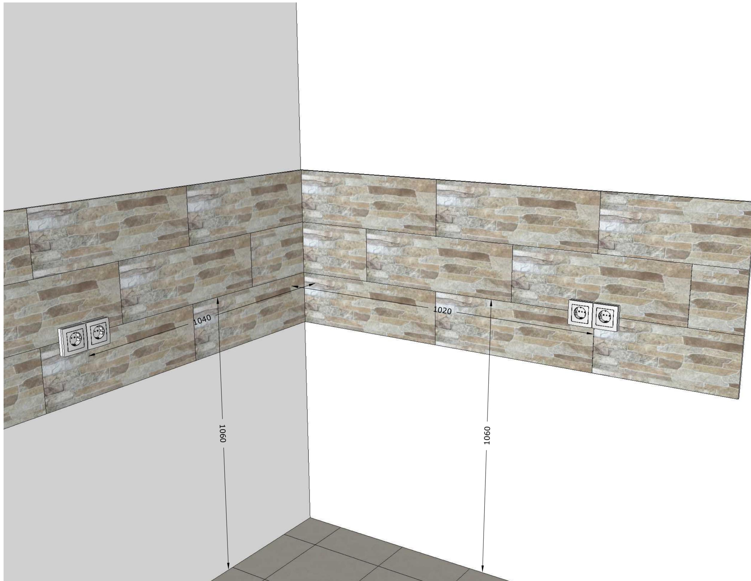
План розеток на рабочей поверхности 41
